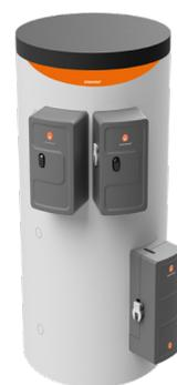
Cascade de modules d'ECS instantanée **FRESH XL**. 2 modules de production d'eau chaude instantanée avec 40 l/min chacun. Montés sur l'accumulateur système SONNENTANK. Débit de soutirage extensible jusqu'à 160 l/min.
