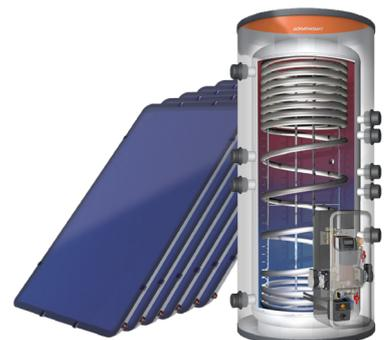
Kit pour eau chaude et chauffage **COMFORT PRO CLEAN (SSC)**. Une eau chaude saine en semi-instantanée (30 l/min) grâce au tube serpentin en inox annelé surdimensionné DN40.
